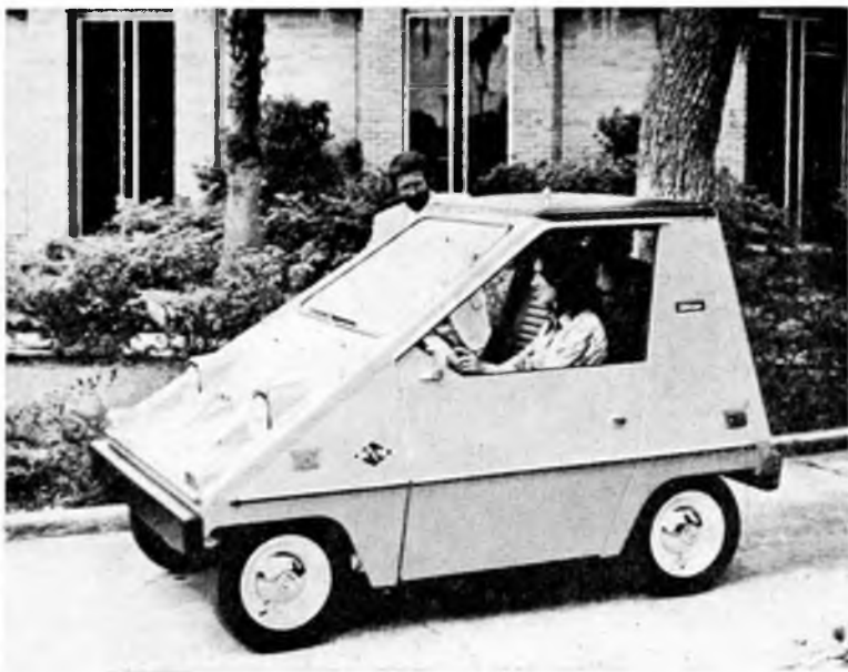
9-4. ábra. Sebring-Vanguard CitiCar kétszemélyes akkumulátoros városi kiskocsi
