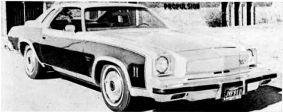
9-3. ábra. Transformer I. akkumulátoros, luxus személyautó
