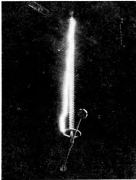
22-5. ábra. A 400 kV-os hosszúrúdszigetelő villamos vizsgálata a VEIKI-ben
