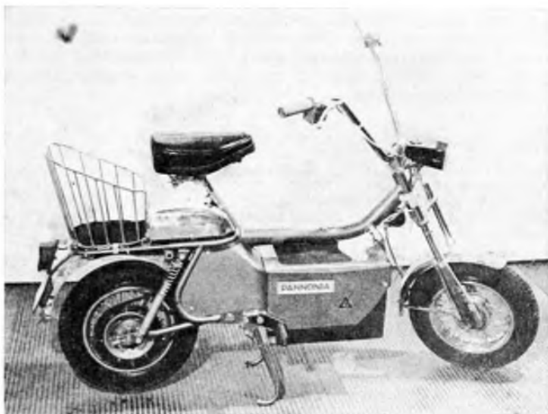
11-16. ábra. Pannonia Electric E 50 villamos kismotorkerékpár
