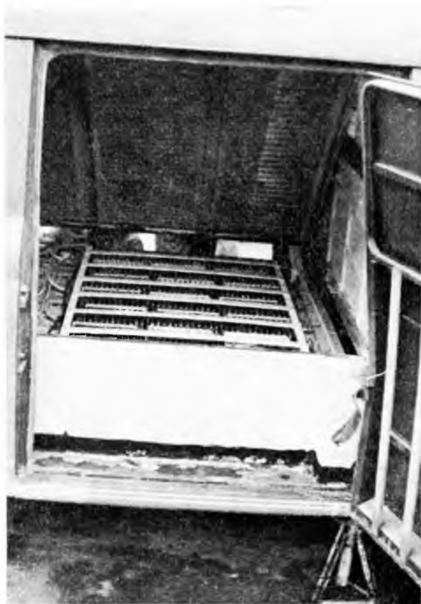
12-7. ábra. A VKI kísérleti Zn—levegő energiátárolós járműhajtási áramforrása
