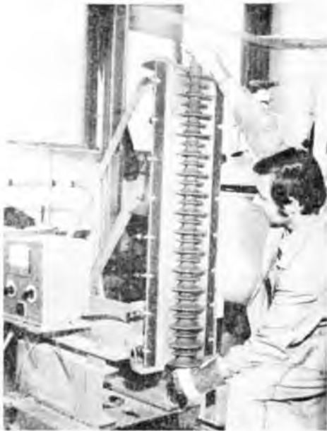
22-3. ábra. A 120 kV-os hosszúrúdszigetelő kiöntése; a kész öntvény kiemelése az öntőszerszámból
