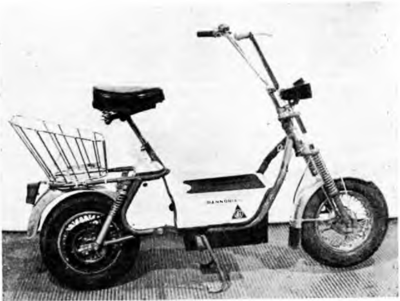
11-14. ábra. Pannonia Electric E 50 villamos kismotorkerékpár
