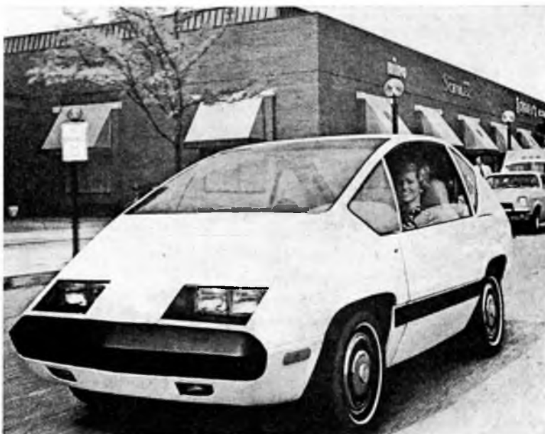
9-5. ábra. Copper Electric Town Car, 2+1 személyes akkumulátoros városi kiskocsi
